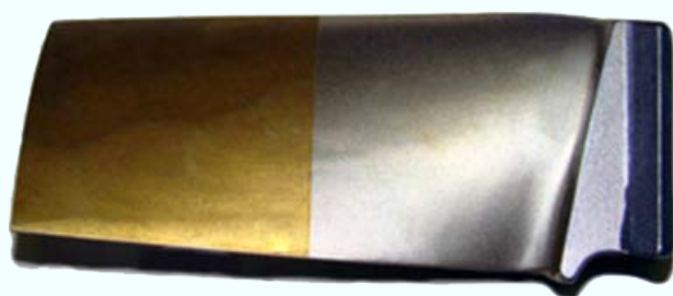
Лопатка газовой турбины с износостойким покрытием
