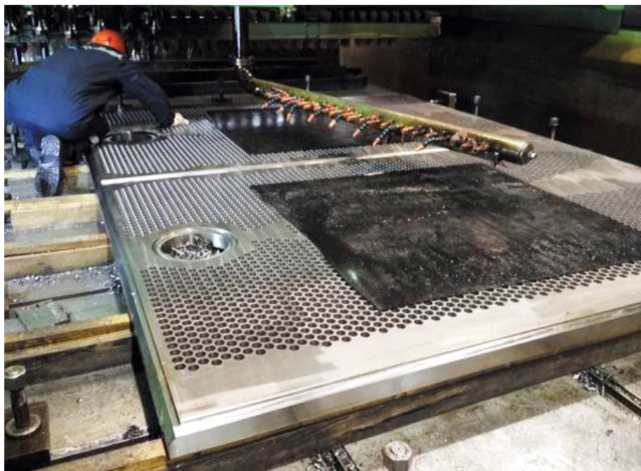
Биметаллическая трубная решетка для конденсатора турбоустановки
