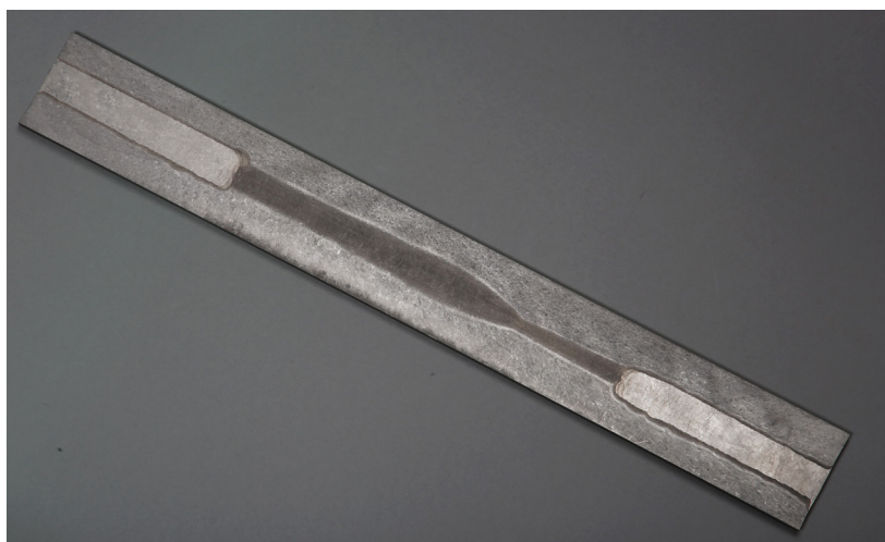
Сварное соединение, выполненное с помощью комбинирования электронно-лучевой и аргонодуговой сварки
