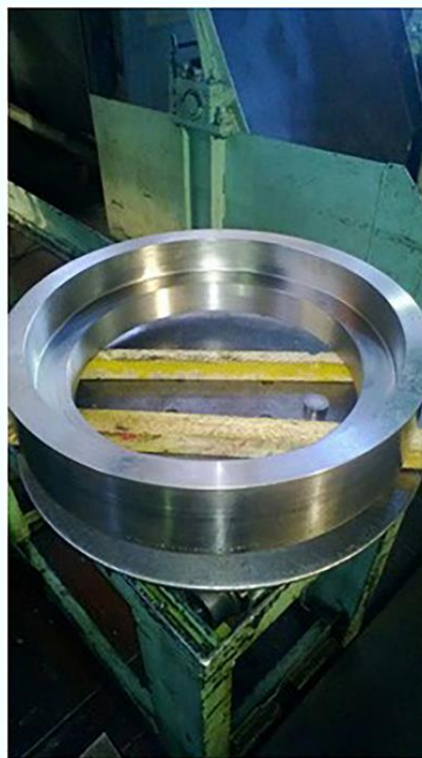
Кольцевые заготовки из сплава марки ХН55МВЦ-ВИ (ЧС57-ВИ), изготовленные методом раскатки
