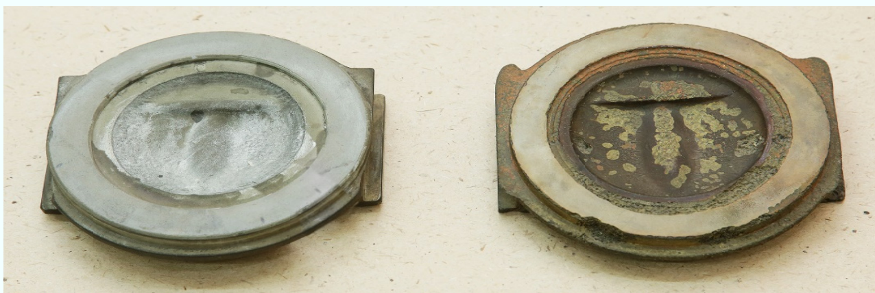
Тарелка клинкетной задвижки (основа – латунь, покрытие – окись алюминия) до эксплуатации (а) и после эксплуатации в морской воде (б) (герметичность задвижки сохранена)
