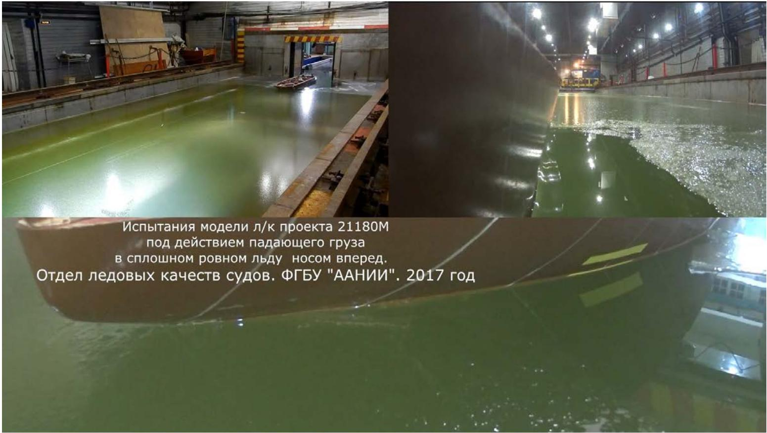
Испытания модели л/к проекта 21180М
