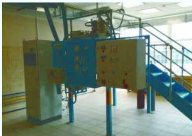
Получение металлических порошков по технологии распыления расплава
