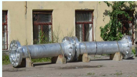
Наноструктурированное покрытие из алюминиевого сплава Al–Sn–Zn, нанесенное методом ХГДН на райзер для морских буровых платформ
