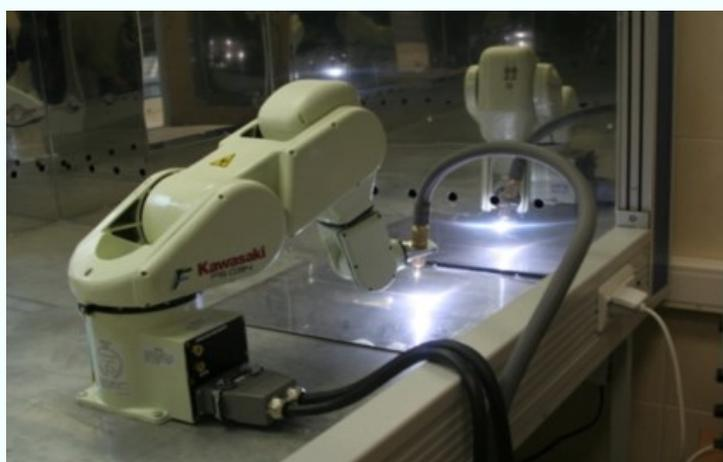
*Установка для микроплазменного напыления «УГНП-7/2250»
