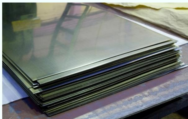
*Плиты илисты из титановых сплавов.*
