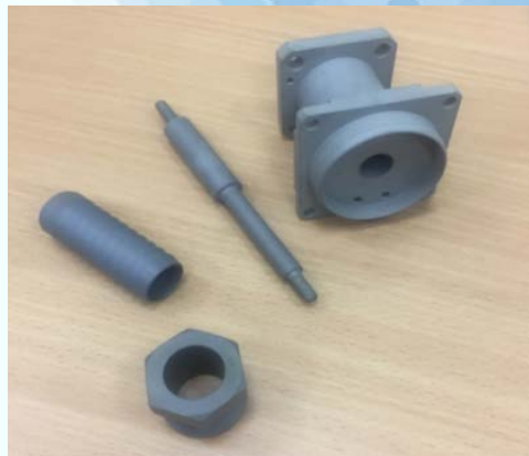
Детали подвижных механизмов с МДО-покрытием
