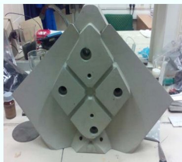
МДО на крупногабаритной плите пресс-формы с площадью поверхности 40 дм 2
