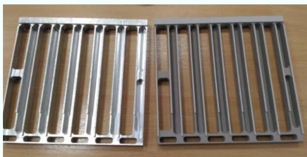
Направляющие системных блоков авиационной техники без покрытия и с МДО-покрытием
