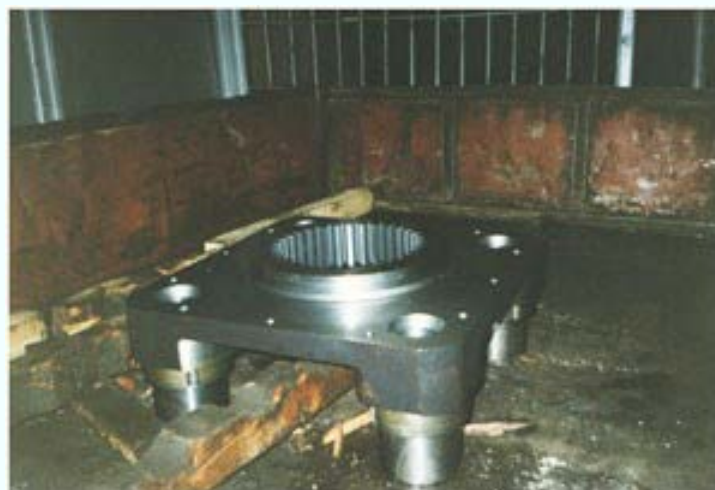
Отливка «Водило» для самоподъемника буровой установки
