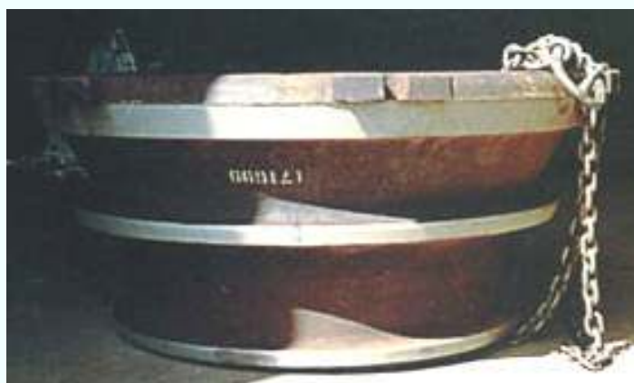
Конус дробилки массой 1440 кг
