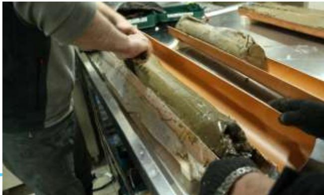
Извлечение образца из грунтовой трубы
