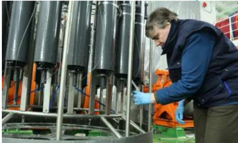
Отбор проб воды для гидрохимических анализов
